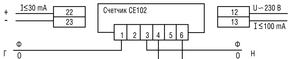
Подключение реле управления нагрузкой к счетчику CE201
