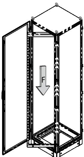
Нагрузка на модульную раму - 1500N
