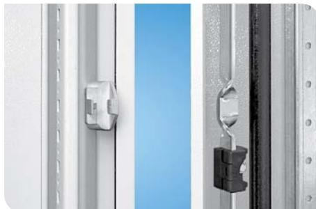
Штанговый замок обеспечивает запирание в 4-х местах, что в комбинации с четырьмя петлями надежно и плотно закрывают двери корпуса. Поверхность двери может оптимально быть использована для размещения оборудования, т.к. замок находится вне проема рамы. Возможна замена стандартного замка с двойной бородкой на замок с поворотной ручкой и профильным цилиндром.
