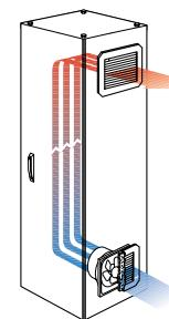
**Применение устройств охлаждения.** Устройства охлаждения используются для понижения температуры внутри шкафа. Применение таких устройств не влияет на степень защиты распределительного щита. Встроенный фильтр обеспечивает их использование в неблагоприятных условиях загрязненного производства, где воздух насыщен частицами пыли и масла.
