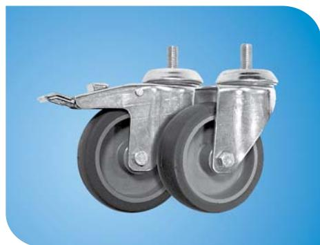
Для удобства перемещения, легко монтируются в стальные закладные рамы, резьба M12. Предельно допустимая статическая нагрузка (на один ролик) 100 кг. Зазор от пола 125 мм.
