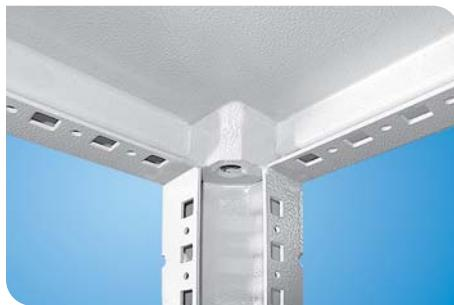
Рама выполнена полностью из стали толщиной 2 мм. Углы рамы усилены стальными закладными элементами и сварены двумя работами непрерывным циклом для придания жесткости и плотности. Профили рамы перфорированы с шагом 25 мм для установки оборудования.
