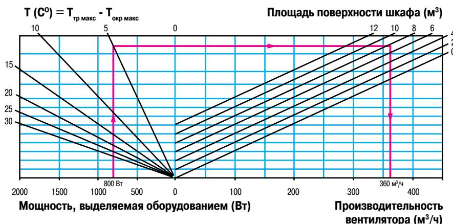
**График определения мощности вентилятора**
