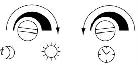
После установки настроек, показанных на рис., любое движение в зоне наблюдения повлечет за собой передачу сигнала приемнику в течение 30 секунд.
