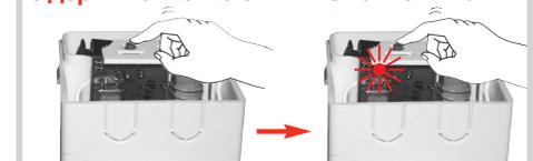
• Для того чтобы перейти от режима передачи только ON к режиму передачи ON и OFF:
