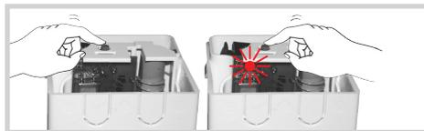
Световой сигнал нового передатчика загорается, затем начинает мигать.
