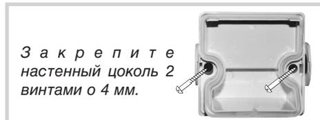
Закрепите угловой элемент 2 винтами 0 4 мм. (а), атем на лицевую панель углового элемента с помощью 2 винтов 0 4 мм прикрепите настенный цоколь(б).
