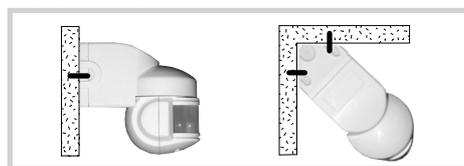
Монтаж на внешний угол - для наблюдения за двумя фасадами; или потолочный - для наблюдения за проходными помещениями и коридорами.
