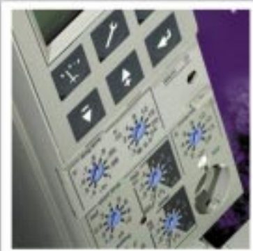
Навигационные кнопки блока контроля и управления Micrologic P
