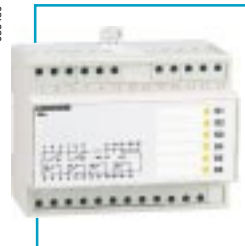
Контакты M6C: реле, расположенное вне выключателя, с 6 независимыми переключающими контактами, управляемыми от выключателя через 3-проводное соединение
